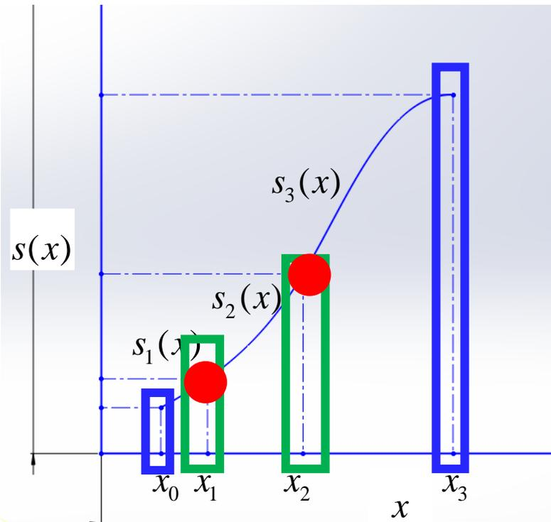
$$\begin{bmatrix} [Continuit\grave{a}] \\ [Alzata\ nodi\ interni] \\ [Alzata\ iniziale\ e\ finale] \\ [Vincoli\ cinematici] \end{bmatrix} \begin{Bmatrix} A_1 \\ B_1 \\ \cdot \\ \cdot \\ E_{n-1} \\ F_{n-1} \end{Bmatrix} = \begin{Bmatrix} [0] \\ [H_i] \\ [H_{1-fin}] \\ [V; A; J] \end{Bmatrix}$$
