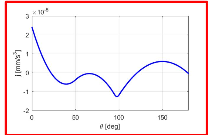
**Obiettivo del progettista:** Realizzare un diagramma delle alzate compatibile con i dati, che soddisfi dei requisiti cinematici richiesti (accelerazioni massime contenute, velocità nulle in alcuni punti, jerk elevati ridotti)
